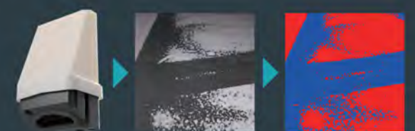
カメラ・マイコンを内蔵した融雪制御器で積雪の有無を判定
